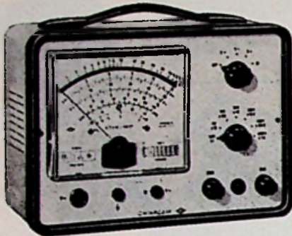
Buis Volt Meter ingangsimp. 22 MΩ 41 meetbereiken
